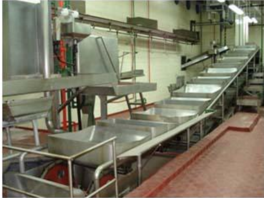
NORIA DE BANDEJAS DE ACERO INOXIDABLE PARA VISCERAS
