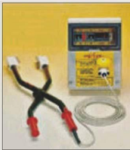
Pinza y fuente de poder para aturrido de cerdos
