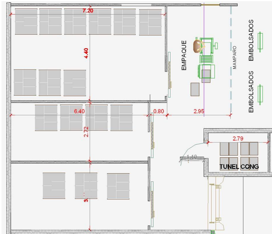
Cámaras de depósito de congelados
