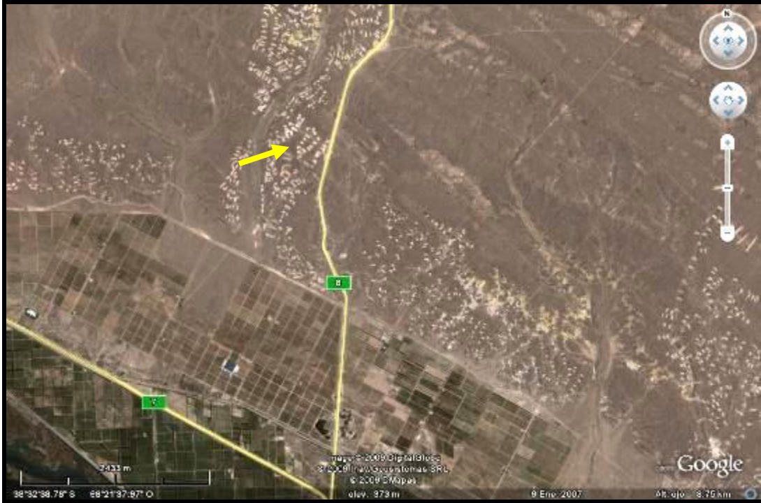
Figura 22. Microdiques de contención aluvional, en la unidad de pedimentos de flanco, hacia el norte del área de proyecto.
