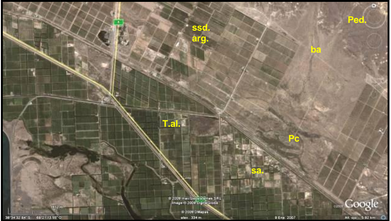
Figura. 21. Características generales de suelo y paisaje en el sector noroeste del área de proyecto. Unidades de paisaje. T. al. Terrazas aluviales; Ped. Pedimentos de flanco; ba. Bajadas aluviales; pc. Paleo cauces; ssd, suelos salinos sódicos; sa. Suelos salinos; arg. Horizonte argílico.
