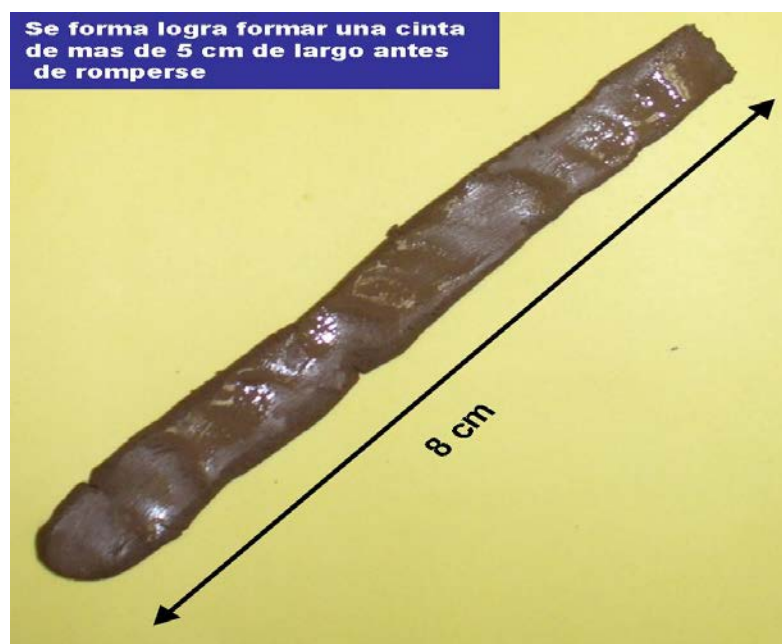
Fig.8 Suelos textura fina Cinta de 8 cm de largo sin agrietamiento
